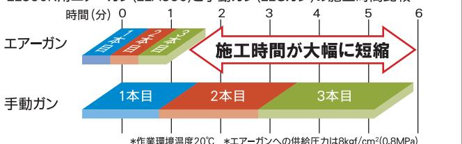
GL450N用エアーガン(GLA450)と手動ガン(GLGガン)の施工時間比較
