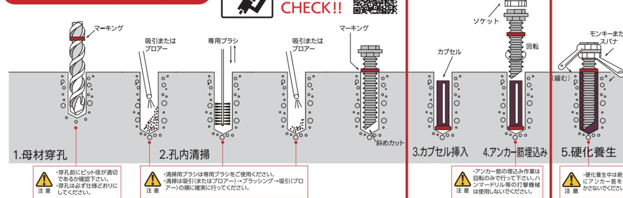
Rタイプの施工手順(回転打撃施工の場合)
