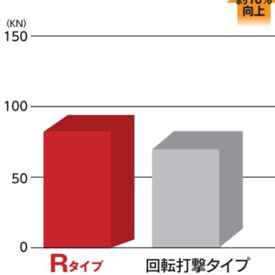
※試験条件:アンカーボルトM16 埋込深さ130mm
