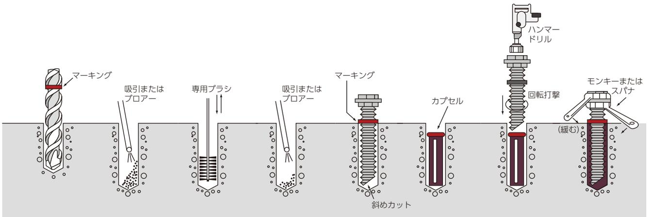
**回転方式** … ボルト等を回転のみで、カプセルを破砕・混合させながら埋め込む方式
