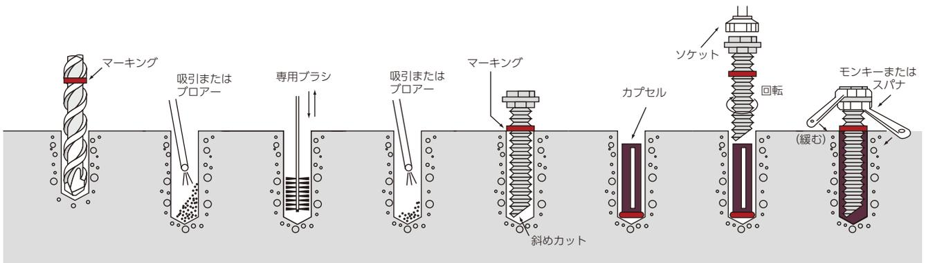
**打込み方式** … ボルト等をハンマー等で打ち込み、カプセルを破砕・混合させながら埋め込む方式
